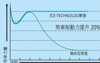
ICE TECHNOLOGY 碟盤的散熱效果
