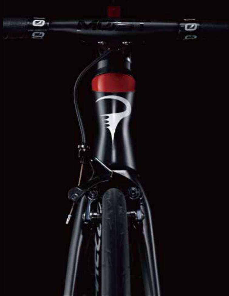
全新Dogma F12實現可能的整合式全內走線系統(一體把、頭碗、車架的整合式設計，搭配全新Talon Ultra一體式把手)
