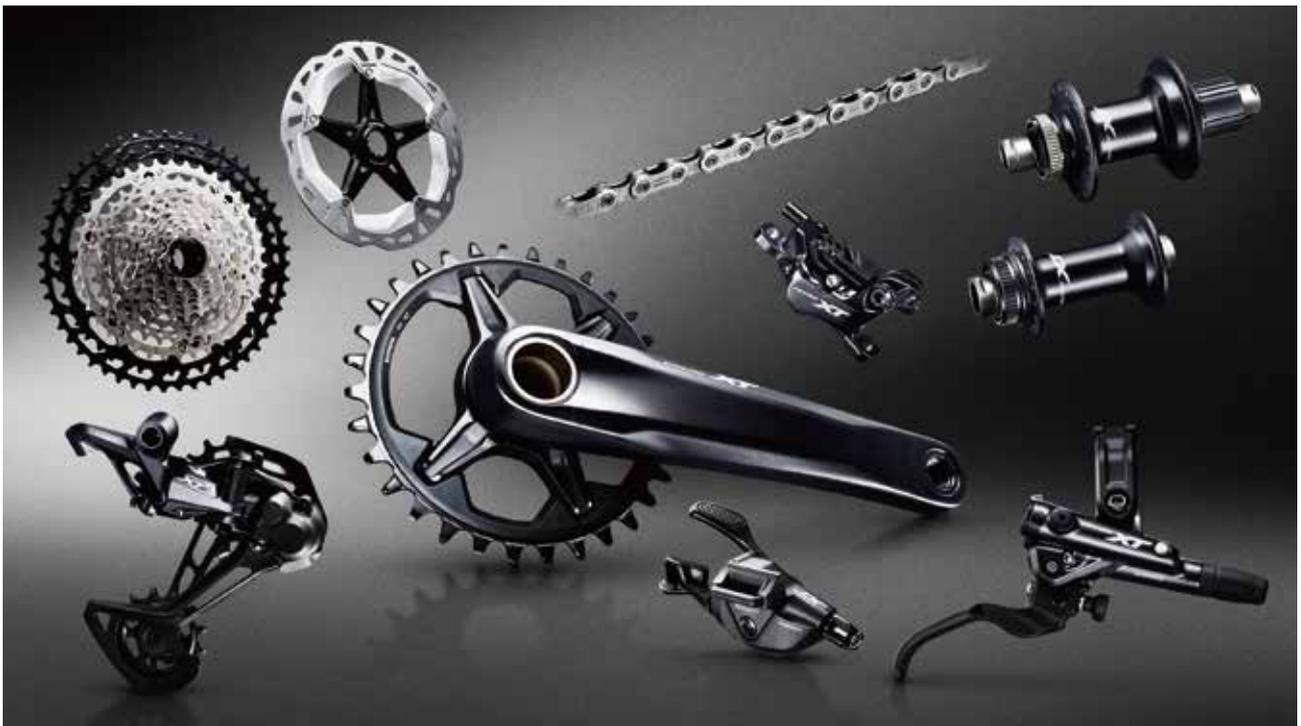
**大齒盤：**全新DEORE XT 1x12大齒盤特色為延襲HOLLOWTECH II曲柄的設計，以及中空技術曲柄。齒片搭載DYNAMIC CHAIN ENGAGEMENT+特殊齒尖形狀設計，特殊的厚薄齒交錯的設計便是提升鏈條張力保持、提供滑順及安靜的傳動的主要關鍵。齒片採用直鎖式的鎖固方式，可安全和快速的更換齒片，並簡化更換齒片的程序。大齒盤擁有28T、30T、32T、34T和36T的齒片規格，可與XTR和新SLX等級的齒片互換。曲柄規格有165mm, 170mm, 175mm和180mm。DEORE XT大齒盤有3種chain line的規格：
