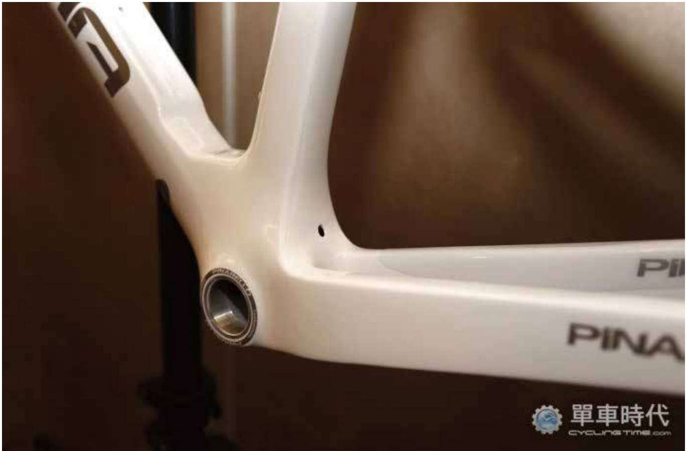
與F10同樣使用最高等級的抗拉強度的Torayca T1100 1K 碳纖維來打造DOGMA F12車體
