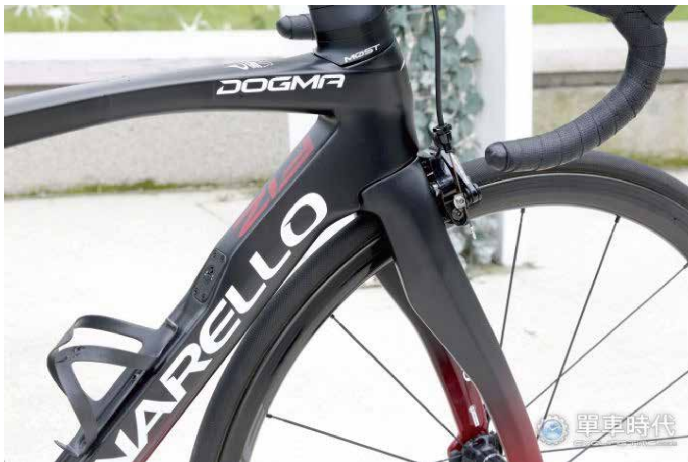
全新加大斷面的ONDA前叉，以DISK版本來看，DOGMA F12相較F10可減少了15.7%的風阻
