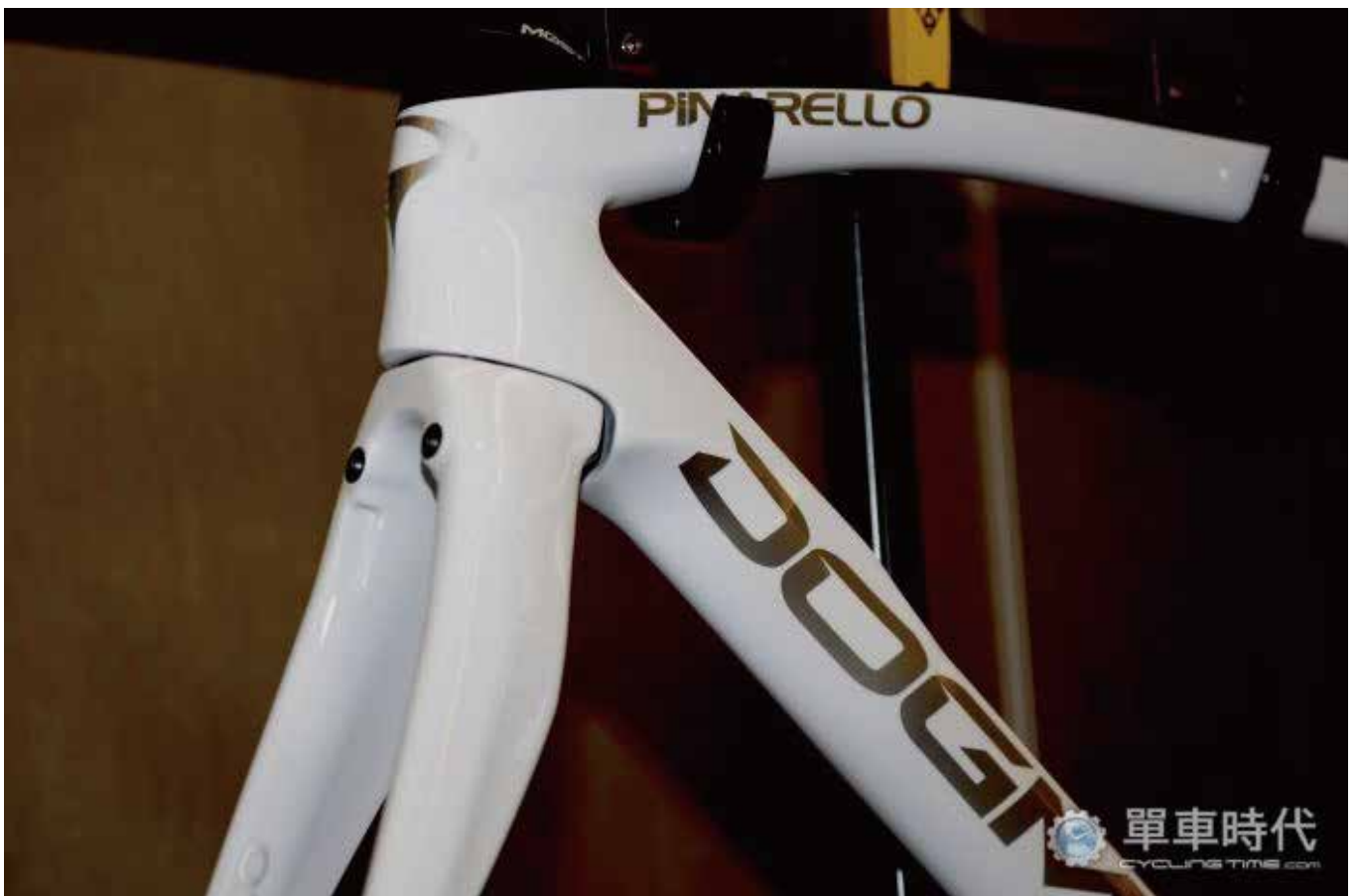
直鎖式夾器的煞車力道直接加載於前叉，不僅可增加煞車系統的剛性，同時提升煞車制動力
