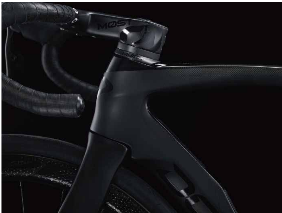
頭管部位重新設計：上方區域加大以利1" 1/2頭碗培林的安裝，並整合成更有空氣力學效率的管型
