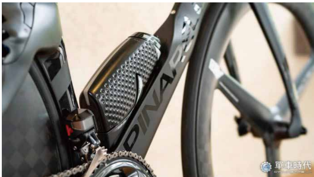
水壺；它前面較寬、後面較扁的設計，讓水壺隱藏在車架後面，助於減少風阻
