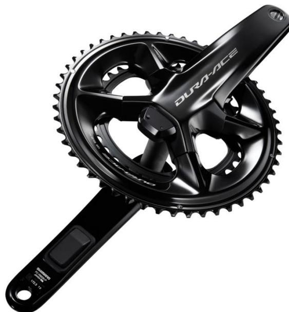
傳動系統的核心就是曲柄組。此系列提供整合式功率曲柄組 (FC-R9200-P) 及一般曲柄組 (FC-R9200) 兩種版本，均採用 HOLLOWTECH II 原創技術，並提供 50-34T、52-36T 及全新 54-40T 齒比規格，曲柄長度為 160 mm 至 177.5 mm，Q-factor 則皆為 148 mm。
