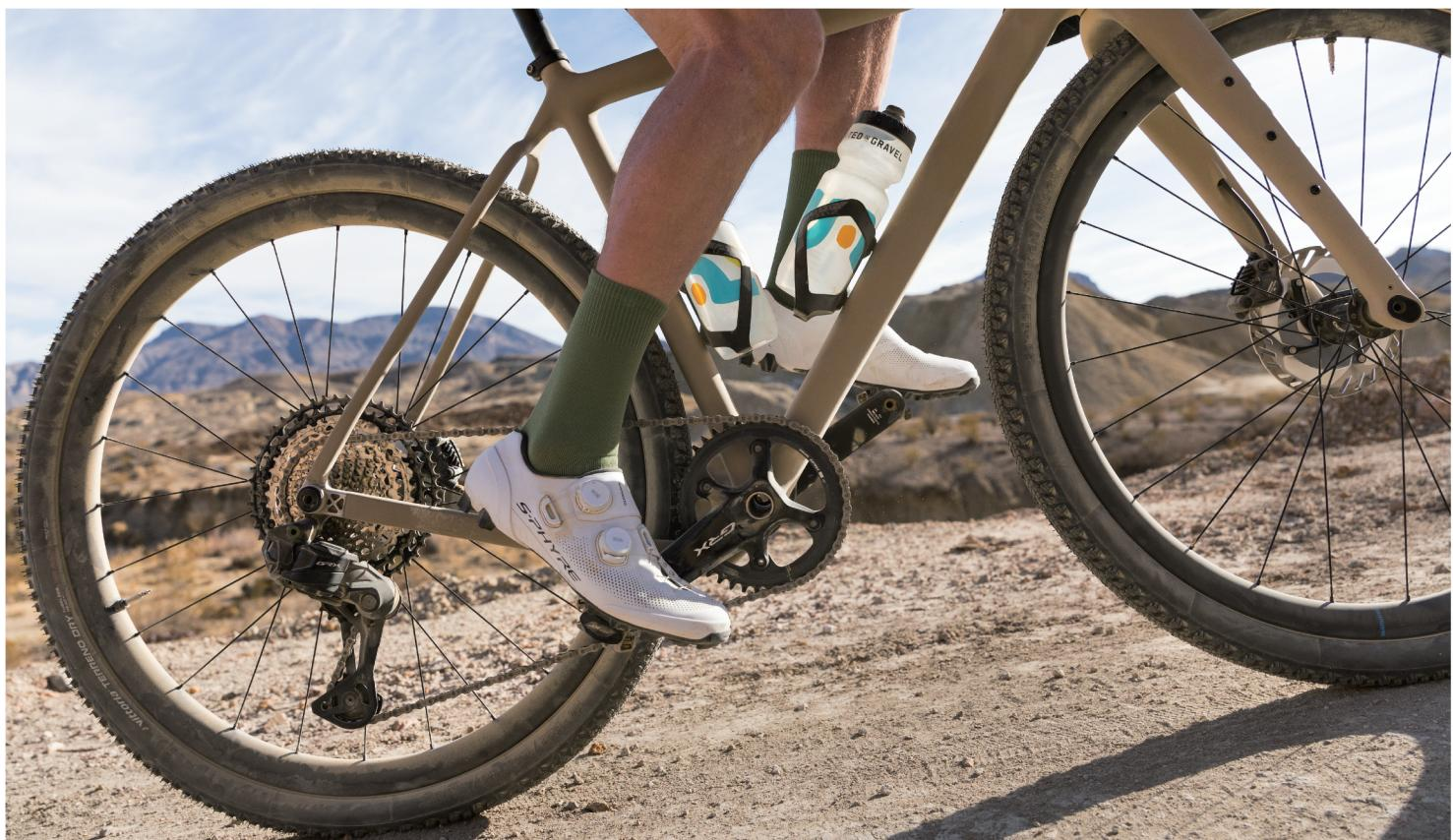
騎乘者可選擇 40T 或 42T 曲柄規格，並搭配 SHIMANO MICRO SPLINE 10-51T 飛輪。而 RX827 也為採用登山車曲柄標準的彎把登山車、探險車提供電子變速選項。無論是攀爬陡峭山路還是在平坦路段漫遊，GRX 系統都能適應任何騎乘風格和地形。
