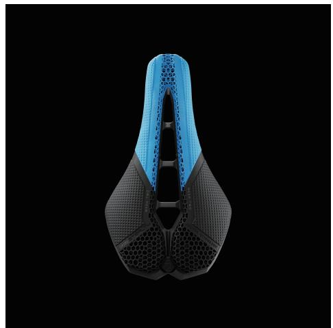
位於後端的低密度區域同時也讓人一窺其六角形蜂巢結構設計，這種結構在座墊中段（中低密度）與鼻頭（高密度）採用更緊密、密度更高的排列方式。除了上述的密度分布外，獨特的六角形蜂巢設計結構進一步提升了舒適感。這些蜂巢設計能獨立且集體地吸收震動，減少路面顛簸傳導，進而降低騎乘者的疲勞感。外露的蜂巢設計展現了 3D 列印技術的精準度，讓座墊外型更加搶眼。
