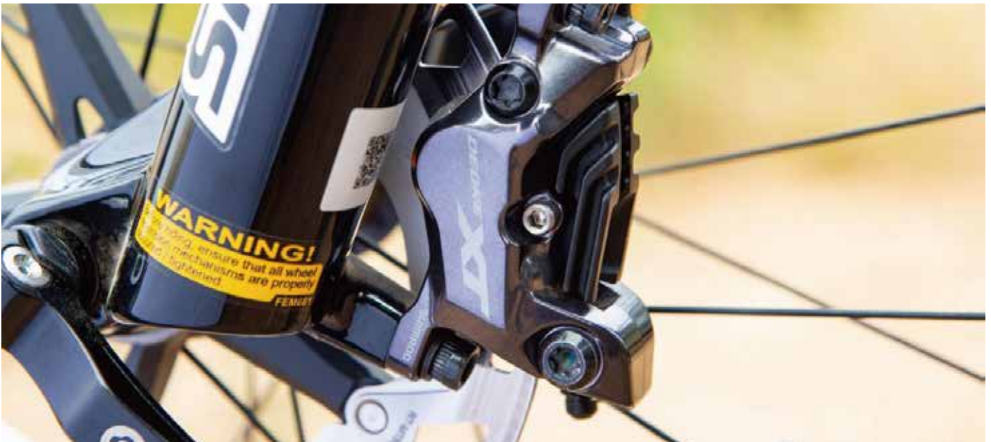
新版本的四活塞卡鉗，更向XTR看齊，除了讓人有高CP值的感受，制動力也更好
