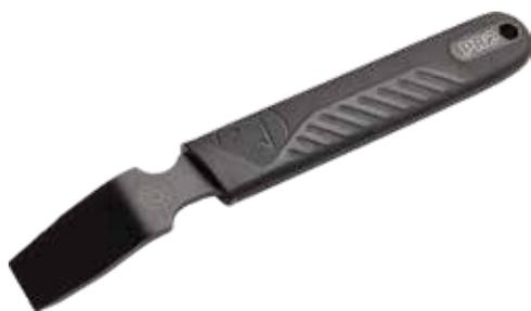
復位碟煞卡鉗活塞的專用工具，使用一個平面的平均施力、避免使用類似一字起子之類的工具單點施力，造成陶瓷活塞破裂。
