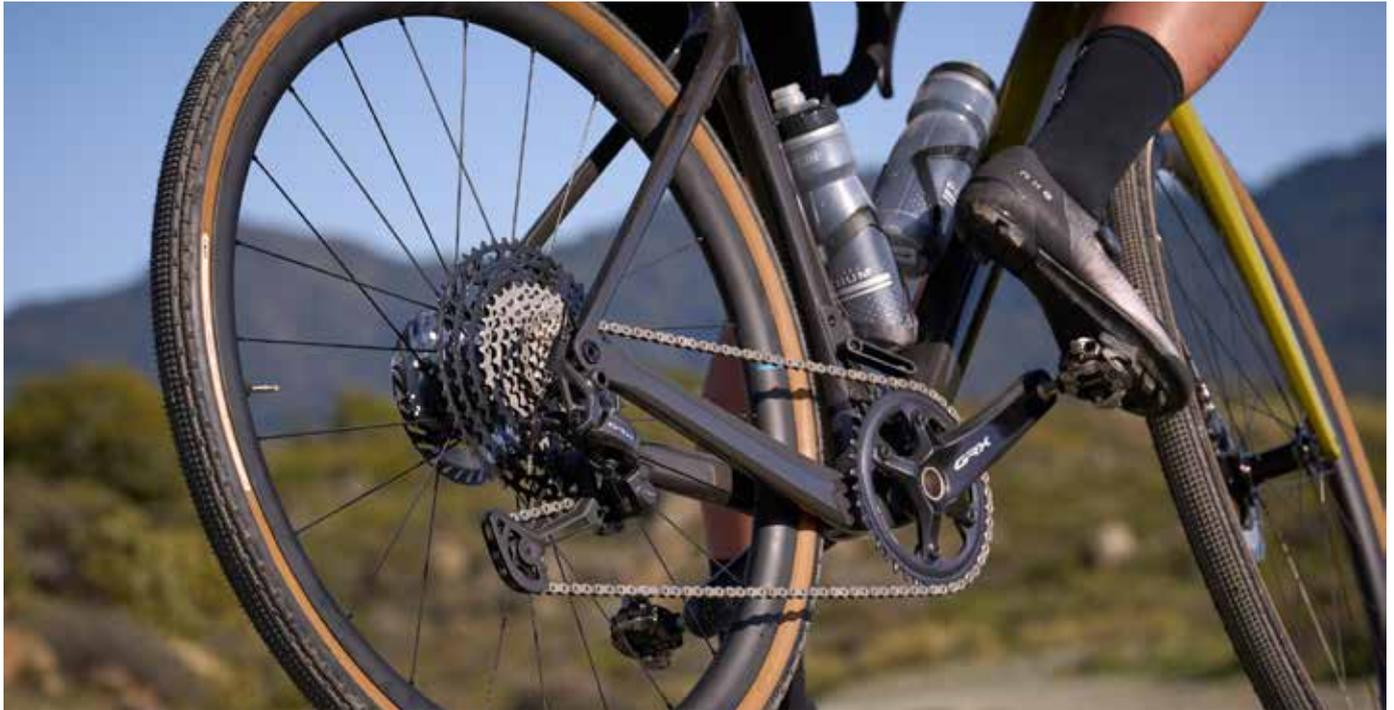
RX820 1x12 速UNBEATABLE採用RD-RX822-GS 長腿後變速器，與10-45T 飛輪規格作使用，加上SHIMANO SHADOW RD+ 鏈條穩定裝置，讓騎乘者在崎嶇地形中擁有更高效的換檔與更安全的鏈條傳動。
