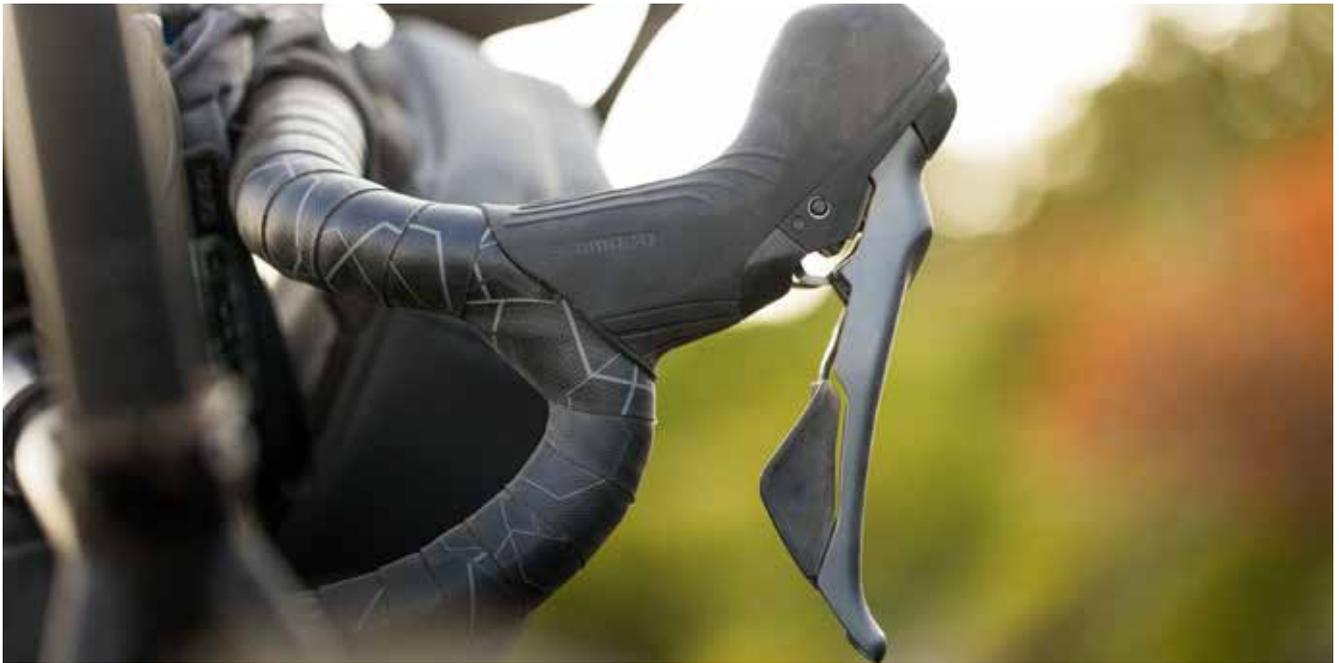
全新GRX雙控把手可提供輕巧靈敏的機械變速。在UNDROPPABLE 2x12速規格中GRX 左變把可提供SHIMANO一如往常的穩定前變速，而在1x12速規格中也有推出GRX左變把支援伸縮座管的功能。
