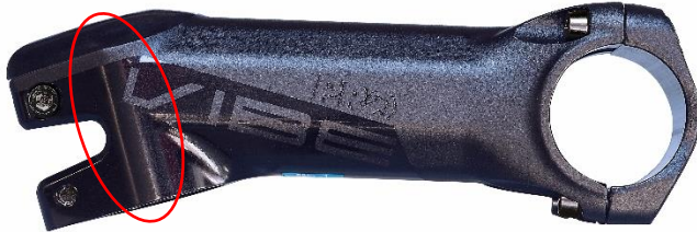
圖 1：前叉立管的夾鉗區域會出現裂痕。
