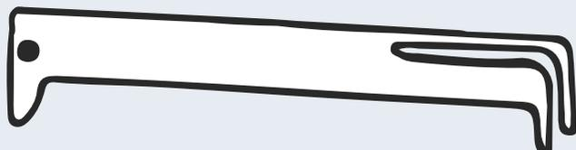
\* 鏈條檢測可以使用 SHIMANO的TL-CN42 鏈條磨耗測量器
